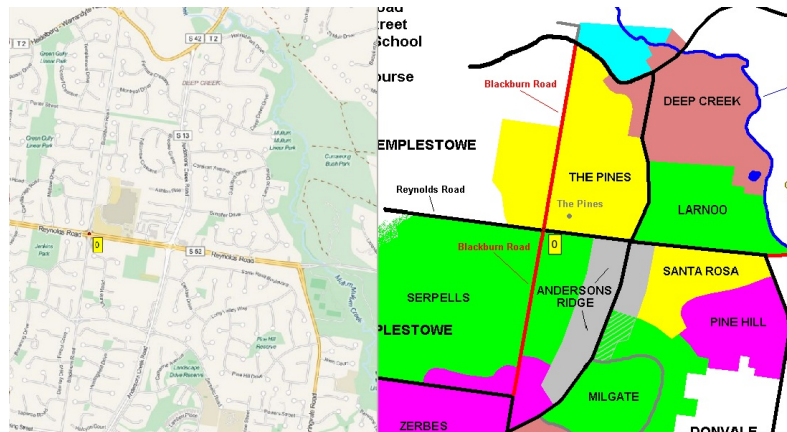
Premier point : à gauche, dans la fenêtre de QGIS (données OSM) et à droite, dans la fenêtre du géoréférencement.
